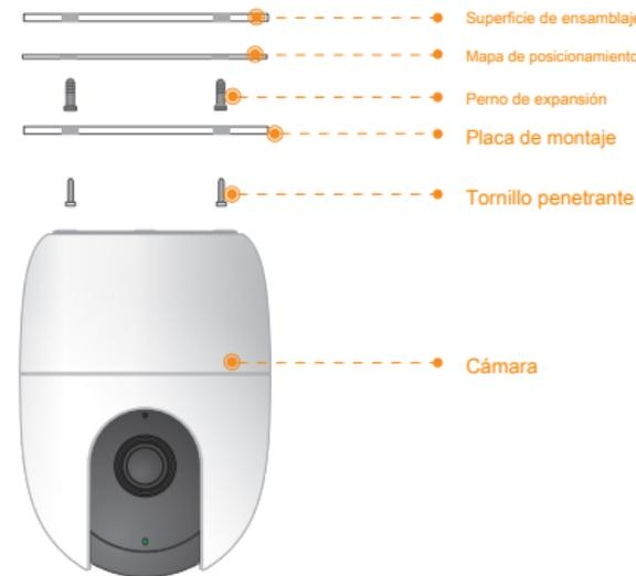
**Paso 1** Taladre agujeros para tornillos en la superficie de montaje como el mapa de montaje muestra, y luego coloque los pernos de expansión.
