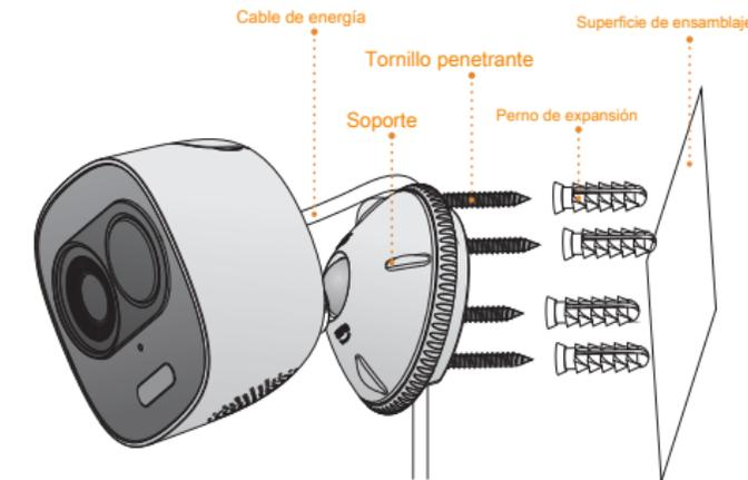
**Paso 1** Taladre agujeros para tornillos en la superficie de montaje a medida que la instalación muestra el mapa de posición y coloca los pernos de expansión.
